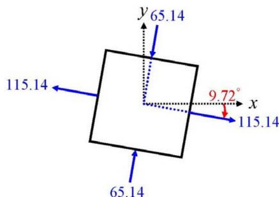
2. 一線彈性材料所製成之均質平板，因受到  $x$  與  $y$  方向上力量  $F_x$  與  $F_y$  之作用，使其處於均勻之平面應力狀態。已知平板之彈性模數  $E = 200 \text{ GPa}$ ，彈性剪模數  $G = 80 \text{ GPa}$ ，三個黏貼於平板面上的應變規(A、B、以及C)所量得之應變分別為  $100\mu$ 、 $250\mu$  以及  $100\mu$ 。試問此平板在  $xy$  面上 (1)所受之正向應力  $\sigma_x$  與  $\sigma_y$  以及剪應力  $\tau_{xy}$  之大小 (9分)，(2)主應變  $\varepsilon_1$  與  $\varepsilon_2$  之大小 (6分)，(3)主應變元素之方向與變形圖 (5分)。(  $\mu = 10^{-6}$ ) (102 中央土木)
