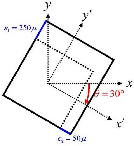
3. 一鋼軸半徑 15 mm，若黏貼於軸上的兩應變規量得應變為  $\varepsilon_{x'} = -80 \times 10^{-6}$  和  $\varepsilon_{y'} = 80 \times 10^{-6}$ ，試求軸中的扭矩  $T$ ，及計算作用在  $x$  和  $y$  方向的應變。(20 分)
