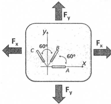
3. 一鋼軸半徑  $15 \text{ mm}$ ，若黏貼於軸上的兩應變規量得應變為  $\epsilon_{x'} = -80 \times 10^{-6}$  和  $\epsilon_{y'} = 80 \times 10^{-6}$ ，試求軸中的扭矩  $T$ ，及計算作用在  $x$  和  $y$  方向的應變。(20 分)
