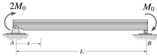
6. (1) 以力矩-面積法求下圖一之 B 支承處斜率。(10%)
